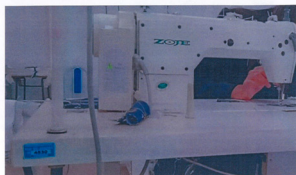
Foto 01. Máquina de costura reta com parada de agulha e caixa acoplada – direct drive. Nº Patrimonial 4530.
